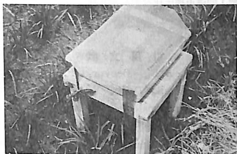
第1図 試験に用いた水盤式トラップ
